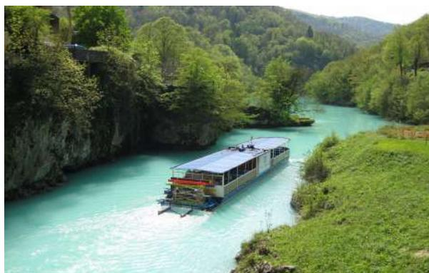
Il battello Lucija è stato convertito alla trazione elettrica all'inizio del 2023. Sul tetto è stata installata una centrale solare, un set di batterie è stato installato nello scafo della barca e una nuova unità di azionamento è stata installata a poppa. Il battello è quindi un mezzo ecologico ad emissioni zero.
