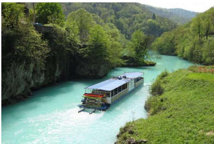
Il battello Lucija è stato convertito alla trazione elettrica all'inizio del 2023. Sul tetto è stata installata una centrale solare, un set di batterie è stato installato nello scafo della barca e una nuova unità di azionamento è stata installata a poppa. Tutto il fabbisogno energetico del battello è coperto dall'energia solare ed è quindi un mezzo ecologico ad emissioni zero.
